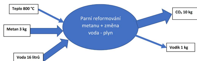
Obr. 29 Parní rozklad zemního plynu
