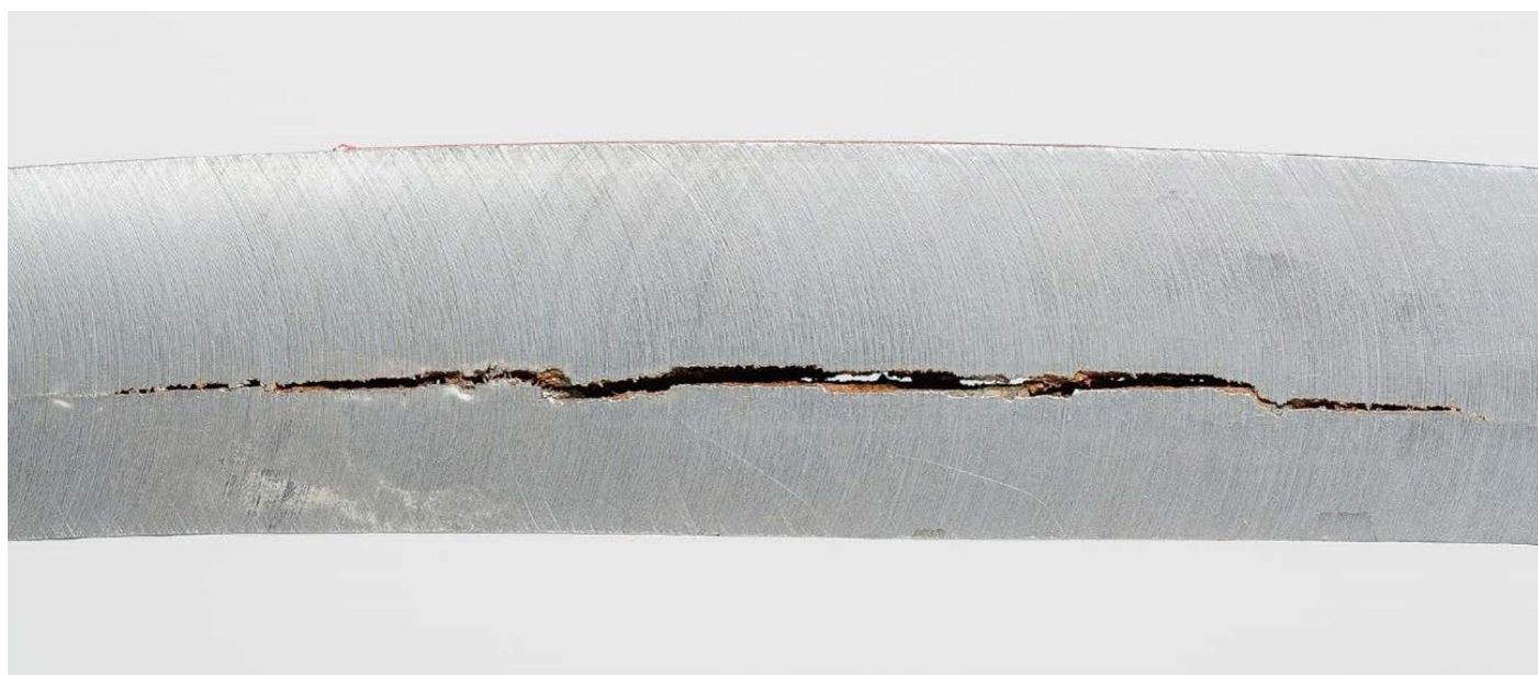
Obr. 32 Trhliny vznikající působením vodíku na ocelový materiál vlivem vodíkové křehkosti
